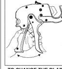
TO CHANGE THE BLADE SQUEEZE THE TRIGGER HANDLE THREE TIMES
