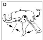
DO NOT SQEEZE THE TRIGGER HANDLE WHILST PUSHING THE BUTTON
