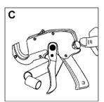
TO RETRACT THE BLADE PUSH THE BUTTON AT THE REAR OF THE TOOL
